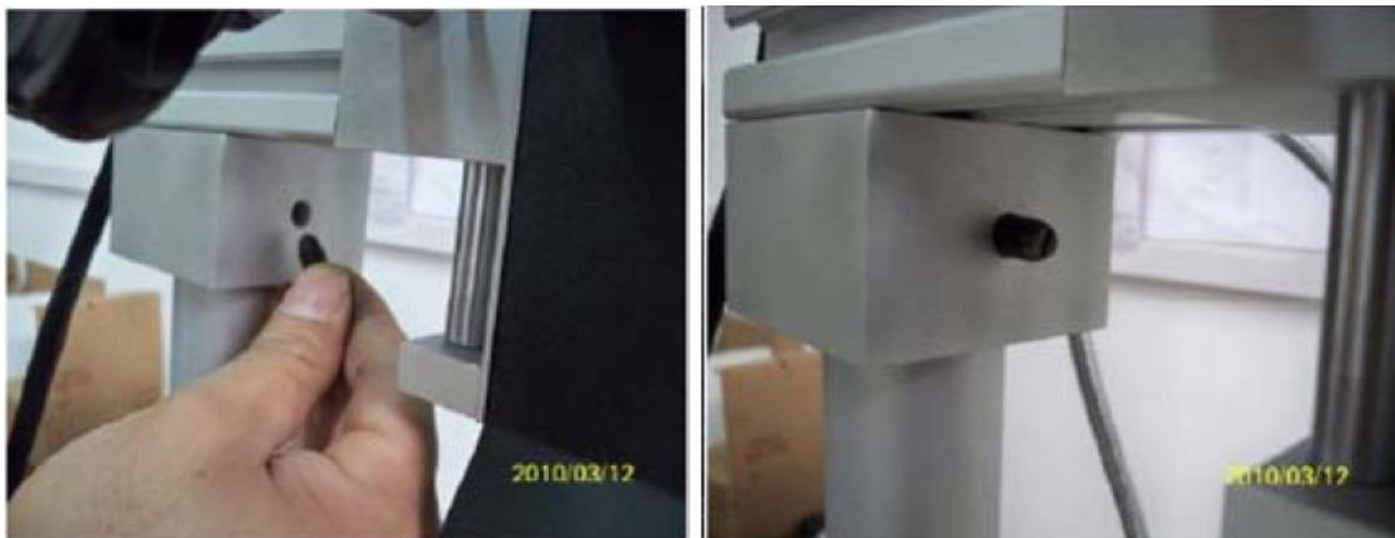
Przyłączenie głowicy podgrzewacza górnego z bazą
