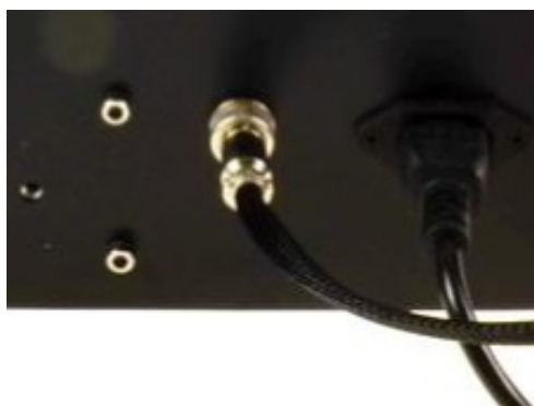
Przyłączenie głowicy podgrzewacza górnego z bazą
